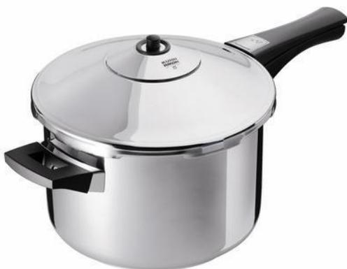
En una olla a presión, tras cerrarse herméticamente, el vapor de agua queda retenido dentro del recipiente. Este vapor produce un aumento de la presión en el interior de la olla, llegando hasta 2 atmósferas (2 atm). Con esta “nueva” presión, el agua dentro de la olla puede alcanzar una temperatura superior. El punto de ebullición del agua a 2 atm es de 120 °C.
