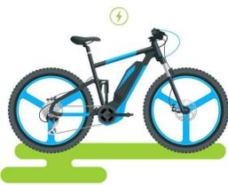
Bicicletas equipadas con un motor eléctrico auxiliar, de potencia nominal continua máxima  $\leq 250$  W, cuya potencia disminuya progresivamente y que finalmente se interrumpa antes de que la velocidad del vehículo alcance los 25 km/h o si el ciclista deja de pedalear (excluidas del ámbito de aplicación del Reglamento (UE) nº 168/2013, de homologación de vehículos)
