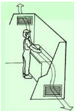
Fig. 4: Sistema de extracción mediante un recinto acotado
