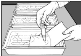
2. Introduzca el papel, con la parte de la emulsión hacia abajo, en la cubeta del revelador. Presiónelo con las pinzas del revelador para que se sumerja completamente.
