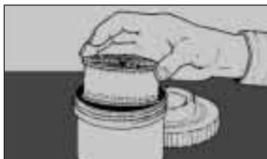
3. Corte final de la película que estaba unido al chasis, introduzca el rodillo cargado en el tanque revelador y vuelva a colocar la tapa. Ya puede encender la luz de la habitación.
