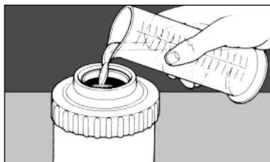
4. Tras comprobar la temperatura de la solución del revelador, viértela rápidamente en el tanque. Cuando esté lleno, golpee suavemente el tanque para evitar burbujas de aire y coloque la tapa que cubre el agujero central.
