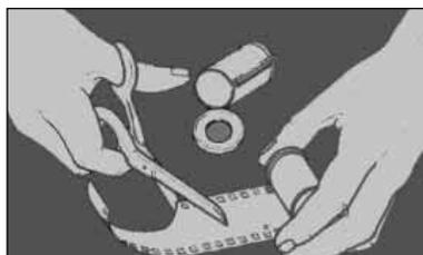
1. En completa oscuridad, abra el chasis mediante la extracción del extremo con un abridor de botellas o con un abridor especial de chasis. Saque la película y corte la lengüeta.
