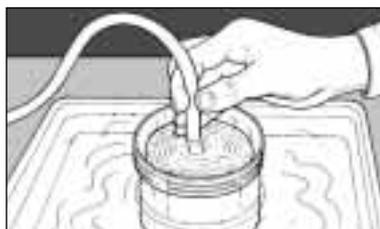
7. Cuando haya terminado el tiempo de fijación, vacíe el tanque, saque la tapa e introduzca una manguera de agua fría en el centro del rodillo. Lave, como mínimo, durante 30 minutos con un chorro de agua. La presión fuerte podría dañar la emulsión.
