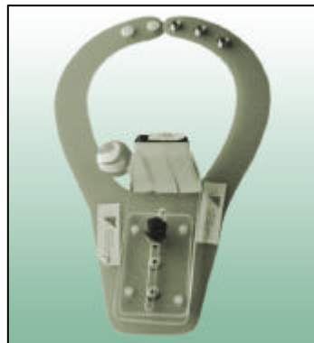
Conmutador colocado en un babero de plástico con un soporte de metacrilato. Graduable en altura. Se acciona con movimientos de barbilla.
