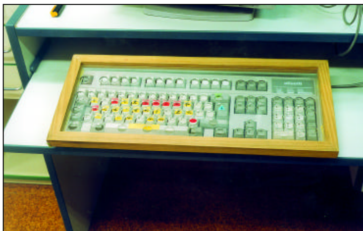
Se ha aplicado un reborde de madera a la carcasa.
